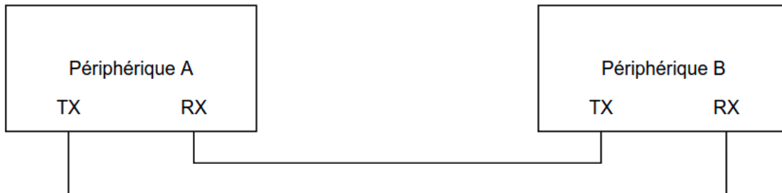
FIGURE 12.8 – Une communication UART
