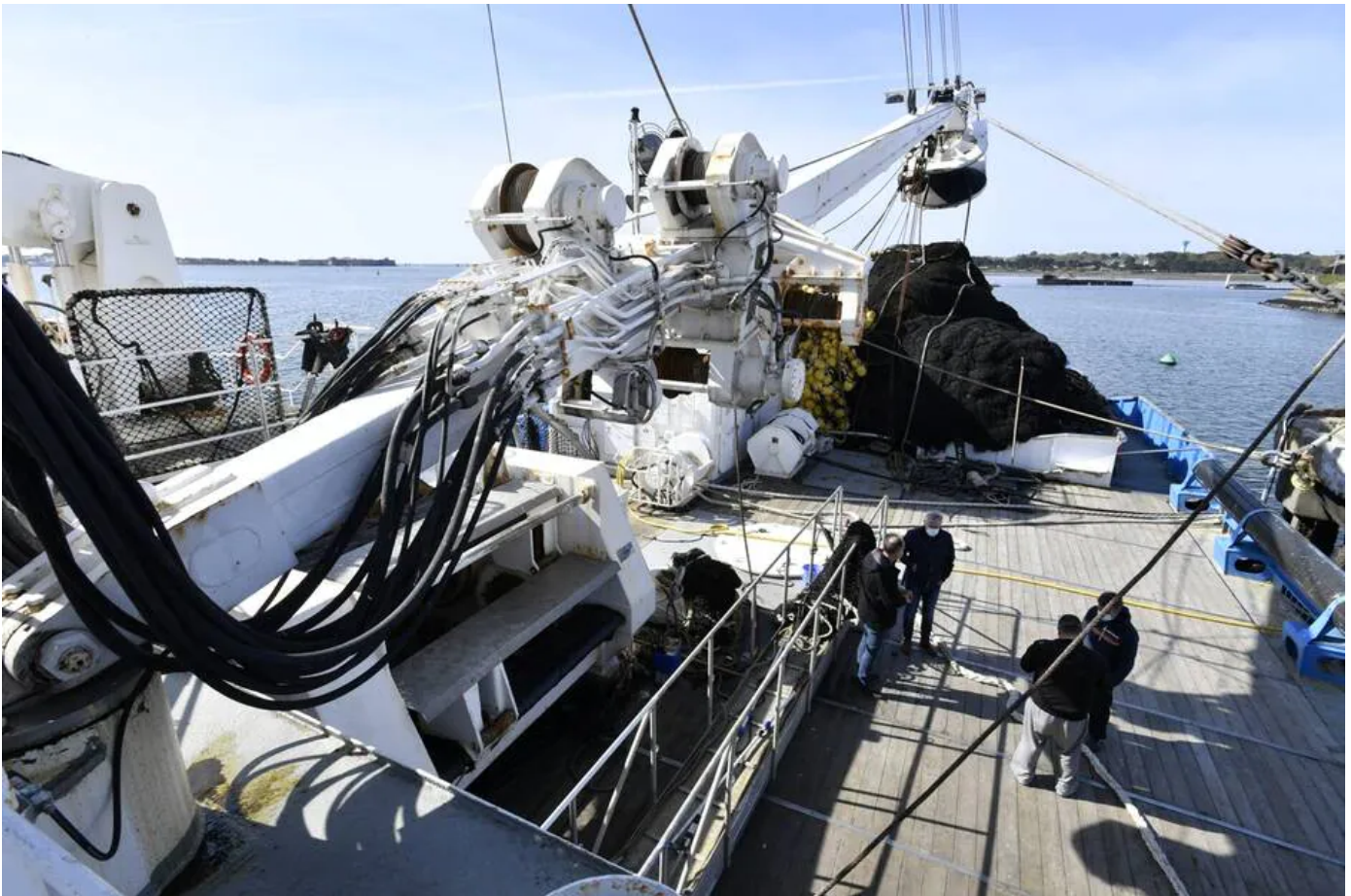
La senne (le filet) à l'arrière du Manapany et son bras de levage équipé du power-block à son extrémité. | THIERRY CREUX / OUEST-FRANCE
