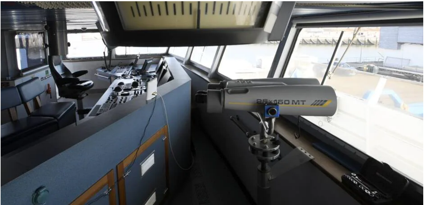
Des jumelles super-puissantes, installées en passerelle, qui permettent de repérer les oiseaux (la volaille dans le vocabulaire du bord) à 15 km. | THIERRY CREUX / OUEST-FRANCE
