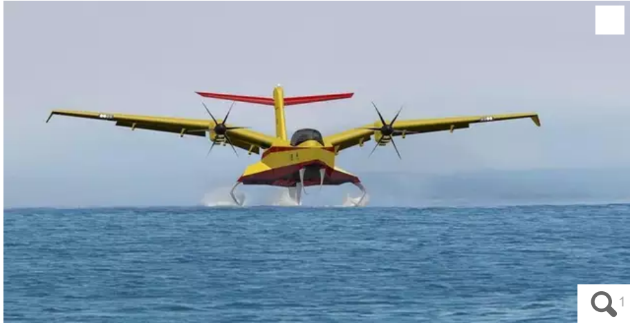
Avec ses foils, Seagle a des capacités accrues de pompage par tous les temps. © Roadfour
