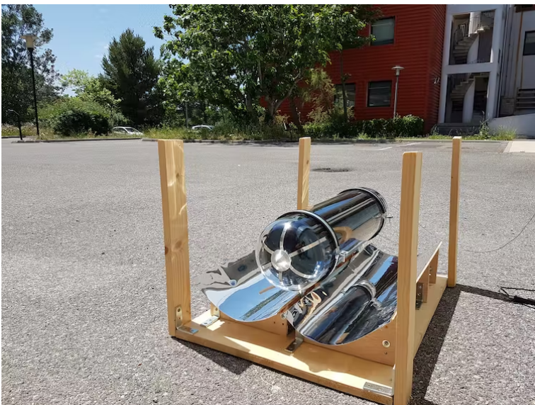
Un four solaire à tube sous vide, atteignant 260 °C grâce à son concentrateur. Thomas Fasquelle, Université d'Aix Marseille, Fourni par l'auteur
