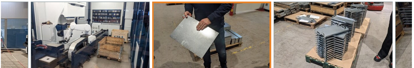
Une tôle découpée mais pas encore pliée pour devenir un châssis ↗
